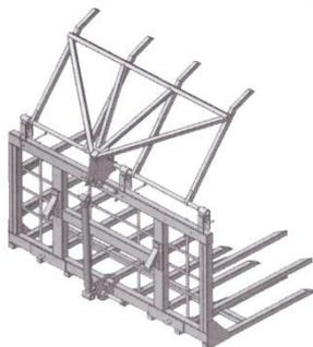
El chasis está diseñado y construido para soportar el trabajo más arduo y distribuir los esfuerzos de manera correcta. Por esto es totalmente aplicable a tareas agrícolas como viales. El cabezal porta accesorios está íntegramente construido en acero plegado y cuenta con fácil acoplamiento y desacoplamiento de todos los opcionales, dando como resultado mínimo tiempo de intervención y puesta a punto.
