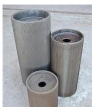
La quebradora se equipa con rolos dentados de distintos tamaños en función del tipo de grano que se requiera moler.
