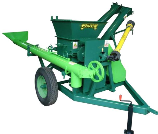
Las quebradoras transportables BERNARDIN son equipos que parten el grano húmedo y lo vuelcan mediante un sinfín a un dispositivo mezclador, obteniendo un alimento pre-digerido con alta calidad con elevado valor energético y digestible prácticamente en un 96%, lo cual se consigue gracias a la fragmentación del grano y la humedad con que se lo expone para la fermentación mediante una adecuada molienda y compactación.
