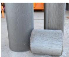
El operador regula la apertura entre los mismos a través de un sistema de manivelas. El producto obtenido por este método se caracteriza por la homogeneidad en el tamaño de quebrado conseguido.
