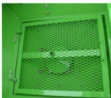
Rejillas interiores de fácil acceso permite la retención de material aglomerado y cuerpos extraños. Removedores rotativos acondicionan el material a ser esparcido.
