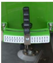
El sistema manual de regulación para la apertura y cierre de la compuerta dosificadora posee una escala milimétrica permite modificar en forma precisa la dosis de producto a esparcir. Un comando eléctrico a distancia desde la cabina del tractor se provee como opcional.
